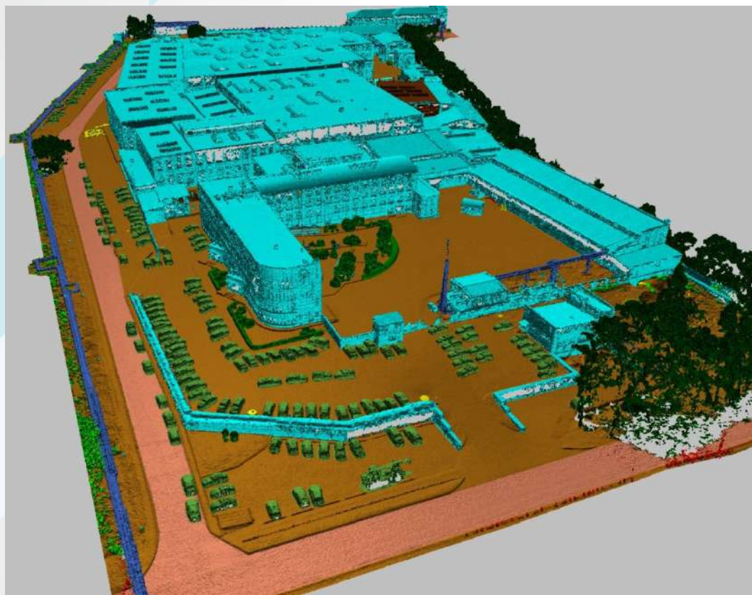
Пример автоматической классификации точек на открытой промышленной территории
