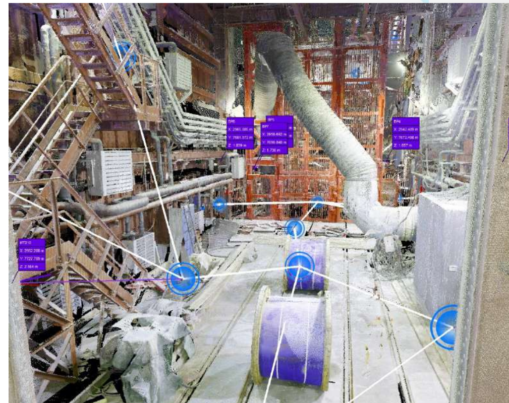
Съемка внутри промышленных цехов с использованием НЛС
