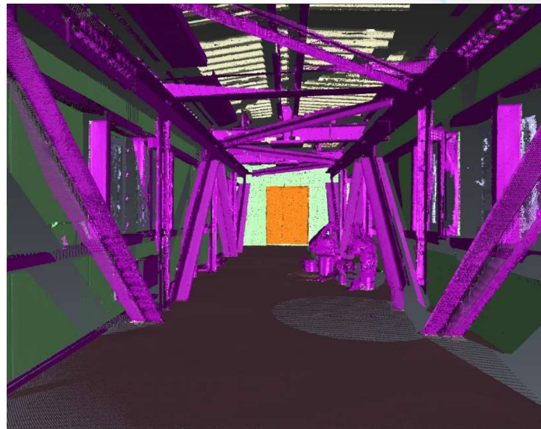
Пример автоматической классификации точек внутри производственных цехов
